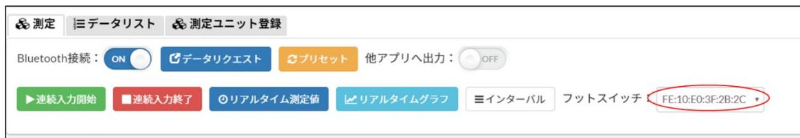
リストから使用するフットスイッチを選択すると、フットスイッチに接続を試みます。このときフットスイッチを一度押すと、接続しやすくなります。
