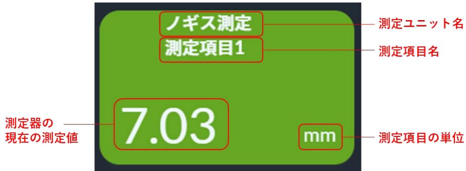
測定値が測定ユニット内の測定項目の規格値から外れた場合、下のように表示窓が赤くなり、かつ▲（上限オーバー）、▼（下限オーバー）のマークが表示されます。
