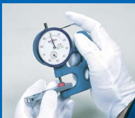
金属ワークの厚さを測定しています。写真では5.98mmを示しています。
