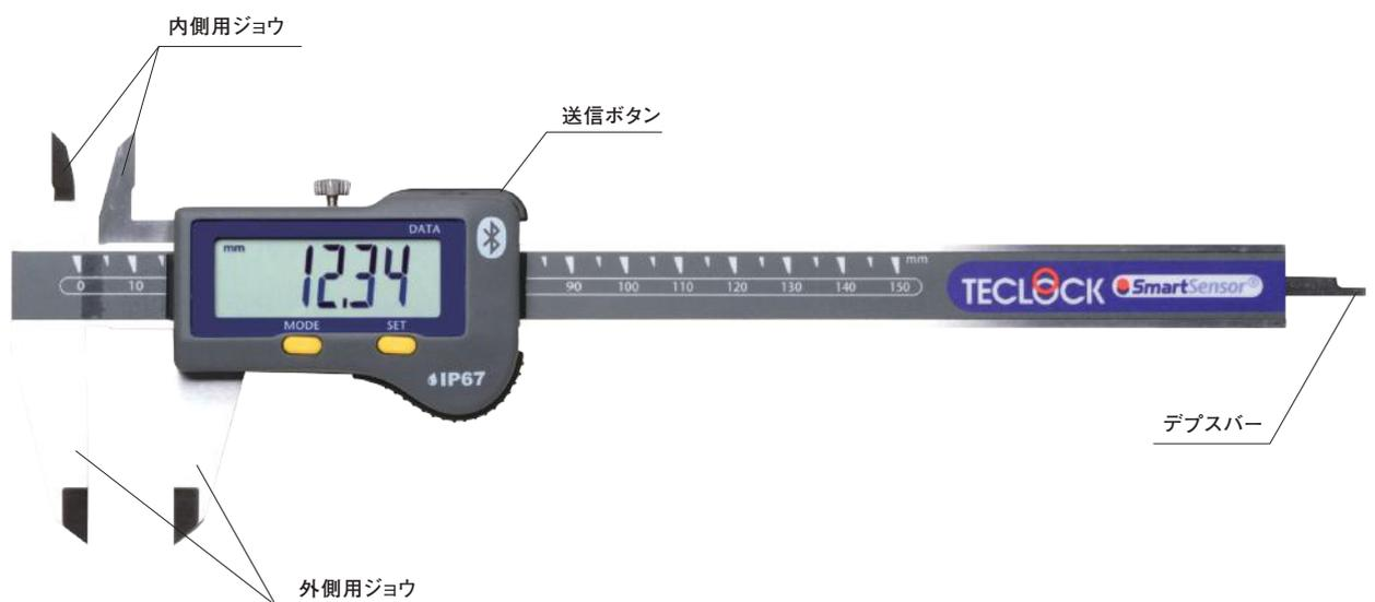
いろいろな箇所を測長できるノギスにおいて、測定範囲150mm、200mm及び300mmの3種類をラインナップしました。Bluetooth内蔵によりアダプタ及びケーブル不要、ワンプッシュで測定データをPCやスマートフォンに無線送信できます。また、大型液晶により非常に見やすい表示となっています。SmartMeasure<sup>®</sup> Lite (無償版) によりPCへ簡単に取り込むことができ、IoT測定システムSmartMeasure<sup>®</sup> (クラウド有償版) へのアップグレードも簡単に対応できます。
