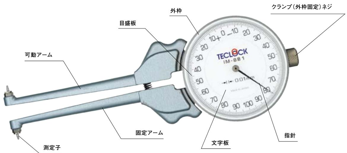
内側キャリパゲージIM-880シリーズは、まず外側に向けた測定子間の距離をリングゲージやマイクロメータなどで基準寸法に設定、外枠を回して連動する目盛板の目盛を0点に合わせたあと測定したい内径部に測定子部分を挿入し測定します。そのときの目盛の0点からの指針の変位量を読み取ります。基準寸法に読み取った変位量をプラス又はマイナスした値が、その内径の寸法になります。このシリーズは、内径の大きさに応じて適確な寸法設定が行なえる替測定子を付属しています。
