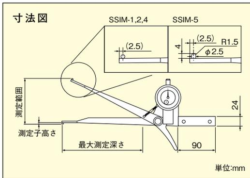
測定物の内側寸法10mm、15mm、20mm、30mm～に対する機種別測定可能深さ
