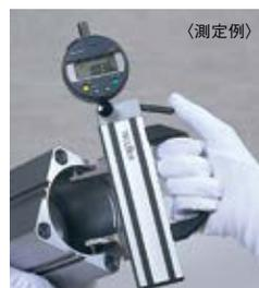
0.001mm表示のデジタルインジケータを使用し、溝の内径を比較測定
