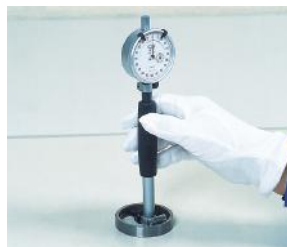
ベアリングの外輪の内径を測定しています
