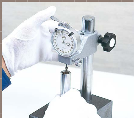
グラナイトベーススタンドにダイヤルゲージを取り付け、ワークの寸法を測定しているところです。
