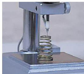
コイルのスプリングの高さを測定しています。
