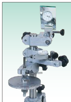
使用例： てこ式ダイヤルゲージの検査
