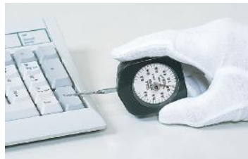
キーボードの押圧力を測定しています
