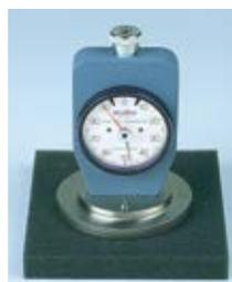
GS-744Gをスポンジシートに置いて、自重で硬さを測定します。発泡具合の分散性も判定できます。
