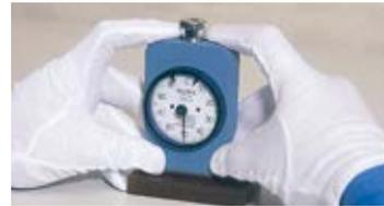
手押しによる硬さ測定は、デュロメータを真上から測定物に押し当て、加圧面を密着させて規格に定められたタイミングで、値を読み取ります。
